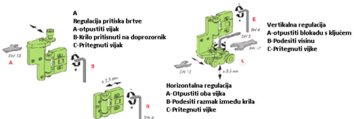
Slika 4.4 Postupak pravilnog štelanja baglama na harmo stijenama
